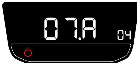
Après quelques secondes, il entre en mode de configuration initiale, ce qui vous permet de sélectionner sur le panneau de commande la puissance maximale de l'unité entre 1.2 (1 230 W) et 2.0 (2 020 W). Sélectionnez l'option souhaitée à l'aide des boutons d'augmentation ou de diminution du panneau ou de la télécommande et confirmez cette option en appuyant sur le bouton ON/OFF de l'appareil.
