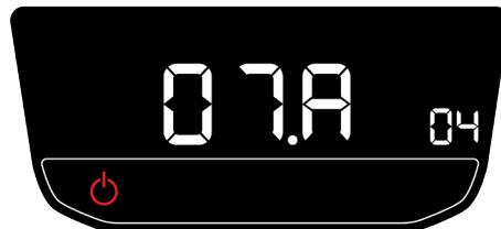
Nach einigen Sekunden geht das Gerät in den Konfigurationsmodus über und Sie können auf dem Bedienfeld die maximale Leistung des Geräts zwischen 1.2 (1230 W) und 2.0 (2020 W) wählen. Wählen Sie die gewünschte Option mit den Auf- und Ab-Pfeiltasten von Bedienfeld oder Fernbedienung und bestätigen Sie Ihre Wahl durch Drücken der Ein-/Aus-Taste am Gerät.
