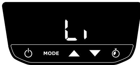
Um die Konfiguration abzuschließen, muss der Benutzer die Maßeinheit für die Temperaturmessung des Geräts wählen (Grad Celsius (°C) oder Grad Fahrenheit (°F)). Wählen Sie die gewünschte Option mit den Auf- und Ab-Pfeiltasten von Bedienfeld oder Fernbedienung und bestätigen Sie Ihre Wahl durch Drücken der Ein-/Aus-Taste am Gerät. Nach dieser letzten Bestätigung schaltet sich das Gerät aus und kann erneut eingeschaltet werden.
